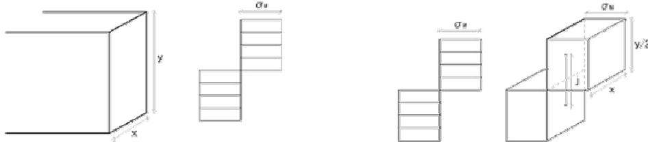
左図の状態における全塑性モーメント (Mp) は応力分布図をちよこっとパースペクティブにしてブロック部分の片方(圧縮 or 引張)の体積にブロック図心間距離(j)をかけた値となる
