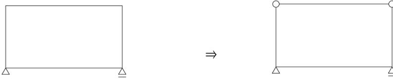
ただし、ピンで接合すると自立できない… ⇒ そこで、斜めの材を追加して…三角形で構成される構造物の出来上がり♪
