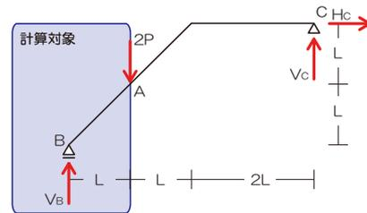
応力⇒切断⇒選択で計算対象を左とする
