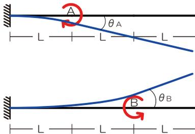
先端部分のたわみ角は A、B 点それぞれにモーメント荷重をかけた際の先端のたわみ角の差となる
