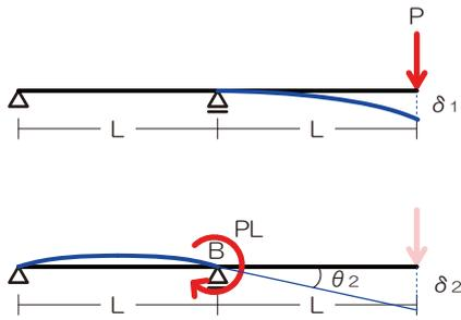
先端のたわみは、片持ち部分のたわみ ( $\delta_1$ ) と単純梁部分の B 支点の傾きによるたわみ ( $\delta_2$ ) の計となる
