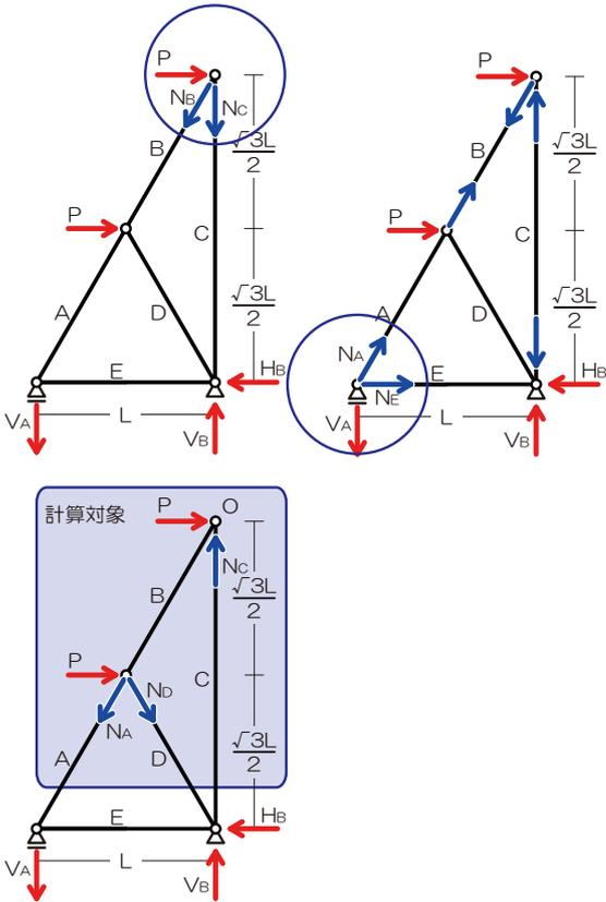
※反力を図示 ⇒ 左図（垂直反力の向きは、水平荷重による転倒を防止するために左側の支点では下方、右の支点では上方となる）
