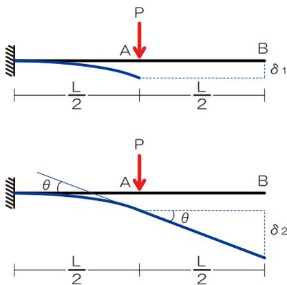
先端のたわみは、支点側のたわみ ( $\delta_1$ ) と自由端側の A 点傾きによるたわみ ( $\delta_2$ ) の計となる
