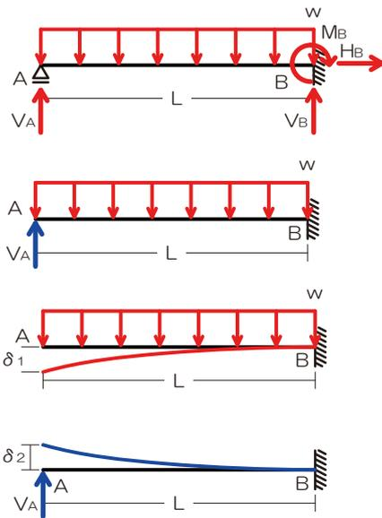
※ひとまず A 点の鉛直反力を求める
