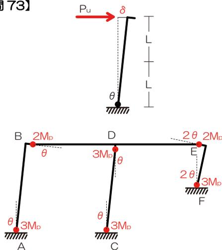
1) 崩壊の図 (崩壊メカニズム) を確認
