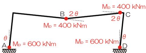
1) 崩壊の図 (崩壊メカニズム) を確認
