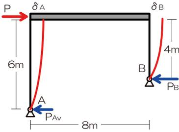
1) 各柱の頂部が水平方向に移動した際の各柱の変形を図示
