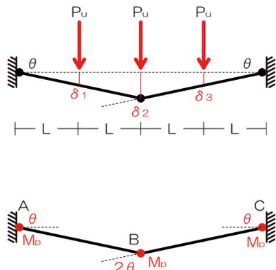
1) 崩壊の図 (崩壊メカニズム) を確認
