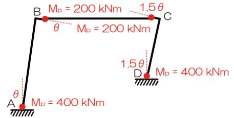
1) 崩壊の図 (崩壊メカニズム) を確認
