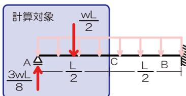
※A 点から B 点に向かって L/2 の位置の曲げモーメントを求める (切断⇒左を選択)
