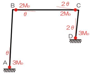
1) 崩壊の図 (崩壊メカニズム) を確認
