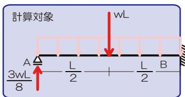
※B 点曲げモーメントを求める (B 点で切断し、左を選択)
