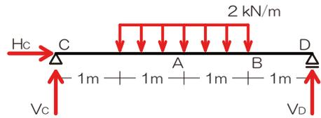
2) 応力を求めたい点で構造体を【切断！】
