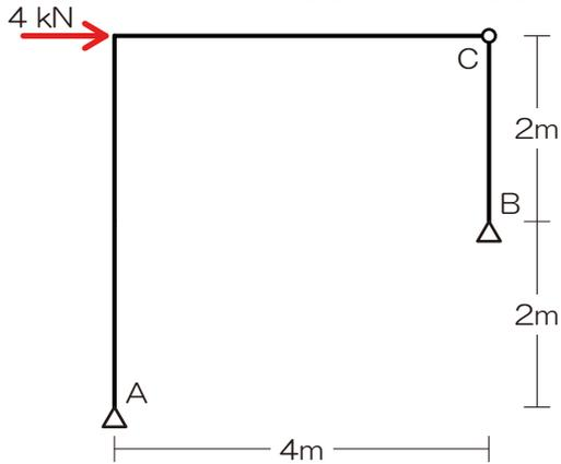
解答 :  $H_A = +4$  [kN]、 $H_B = 0$  [kN]、 $V_B = 4$  [kN]
