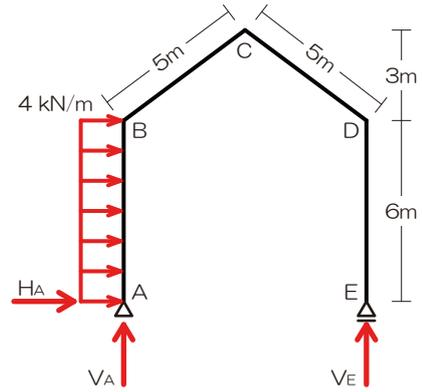
2) 応力を求めたい点で構造体を【切断！】
