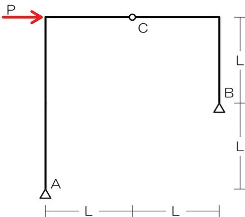
解答 :  $H_A : V_A = 1 : 2$ 、解答2 :  $V_A = -2P/3$ 、 $V_B = 2P/3$ 、 $H_A = -P/3$ 、 $H_B = -2P/3$
