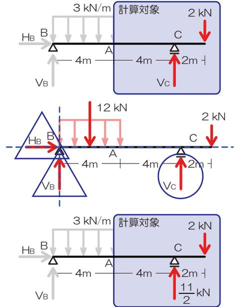
【問 14】応力が変化する (最大値を取る) 箇所は、「支点/節点」「荷重のかかっている点 (分布荷重の場合は重心)」ですので、それらの点の応力を求めれば、最大応力を求めることが可能です
