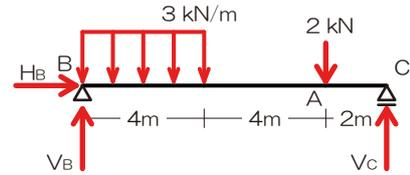
2) 応力を求めたい点で構造体を【切断!】
