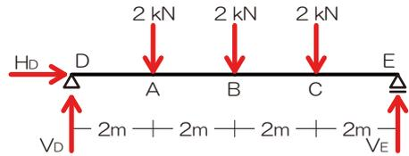
2) 応力を求めたい点で構造体を【切断!】
