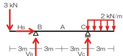
2) 応力を求めたい点で構造体を【切断!】
