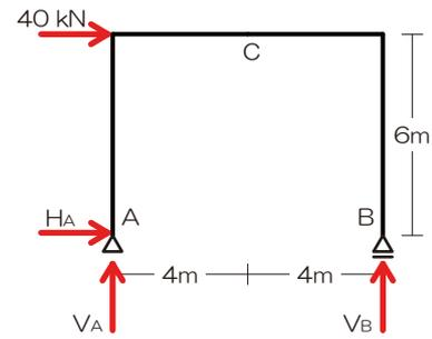
2) 応力を求めたい点で構造体を【切断!】
