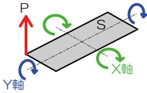
※ 斜めの回転は X・Y の両軸に曲げモーメントによる曲げ応力度を生じさせます
