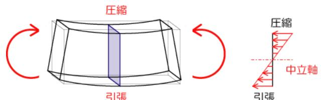
➤ 曲げ応力度は断面位置で値が変化します ⇒ (算定するために) ⇒ **断面位置で値の変わる断面係数**を用いる
