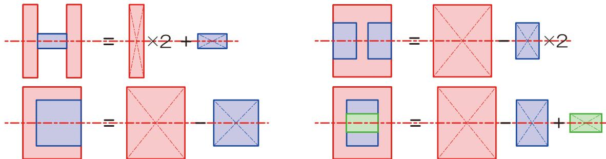
★Ex. 2★ 以下の断面の一点鎖線で示した軸に関する断面2次モーメントを求めてみましょう
