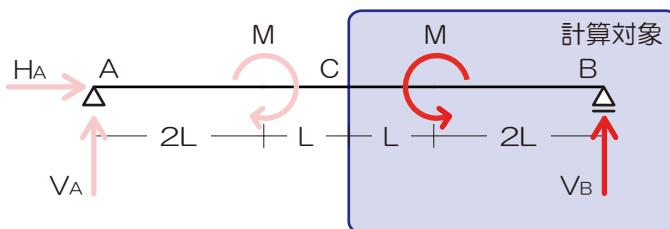
2) 応力を求めたい点で構造体を【切断】！
