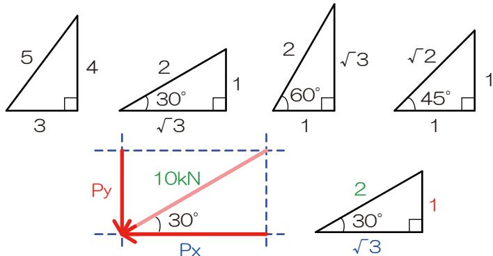
$$\begin{aligned} \text{縦の分力 (Py)} &= \text{斜めの荷重} \times \frac{\text{ちっこい三角形の縦}}{\text{ちっこい三角形の斜め}} \\ \text{横の分力 (Px)} &= \text{斜めの荷重} \times \frac{\text{ちっこい三角形の横}}{\text{ちっこい三角形の斜め}} \end{aligned}$$
