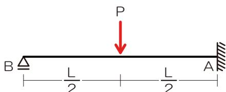
➢ 固定支点って傾かないよね？ ⇒ 元々の荷重や荷重とみなした反力によるたわみ角の計は 0
