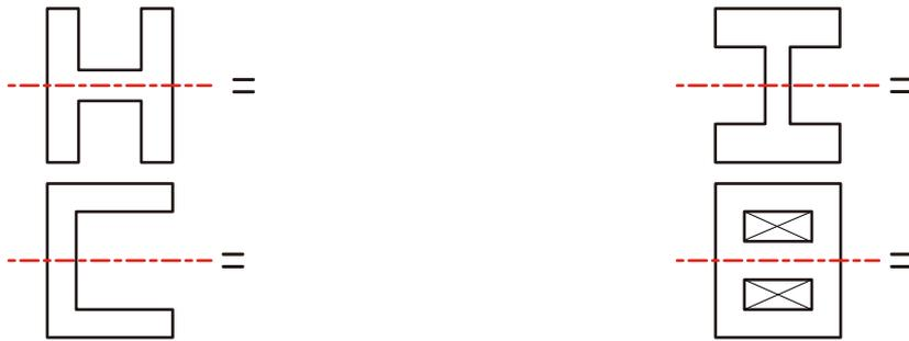
■ 以下の断面の一点鎖線で示した軸に関する断面 2 次モーメントを求めてみましょう
