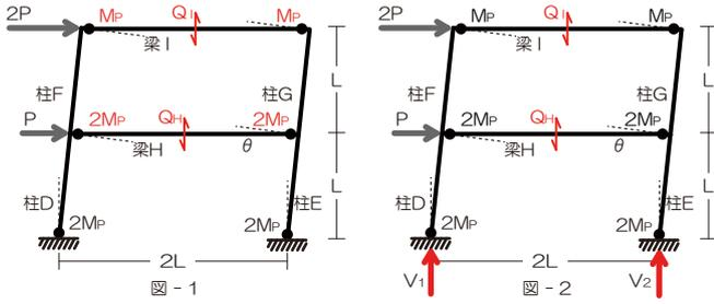
2) 梁の Q ⇒ 柱の軸方向力、鉛直反力 (図 2)
