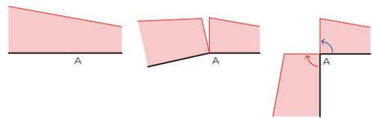
母材から M 図がどちら回転に立ち上がっているの？【小さな風車】に注目すると、打ち消し合って 0 になります（赤風車は時計回り、青風車は反時計回りで合計 0）
