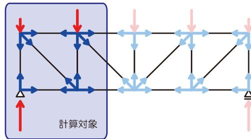
➤ 部材内の軸方向力は力の向きが反対で大きさが同じであるので打ち消し合う
