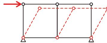
5) 斜めの材を入れて三角形で構成すれば安定する
