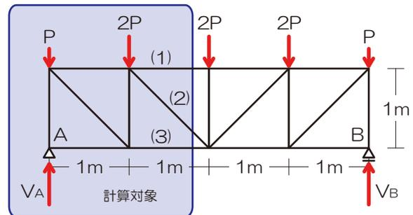
3) 切断された部材内の応力を仮定
