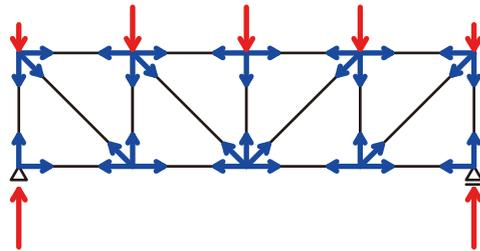
➤ 【応力】は【切断】⇒【選択】であるので以下のように左側を計算対象とする（右側の力は応力算定時には無視）
