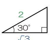
$$\text{縦の分力 } (P_y) = \text{斜めの荷重} \times \frac{\text{ちっこい三角形の縦}}{\text{ちっこい三角形の斜め}}$$
